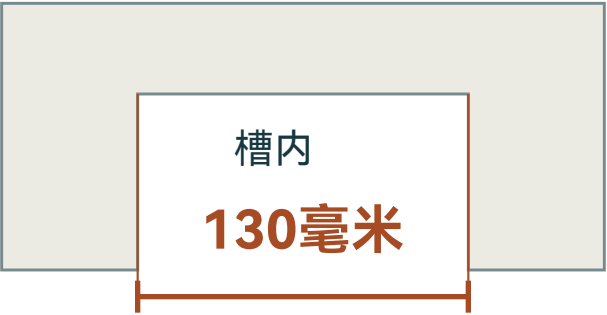
门洞上方顶槽，横截面放大
